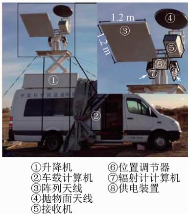
图 1 车载微波辐射计结构示意图
