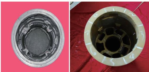
图 13 Mg-Gd-Y 铸造镁合金舱体
