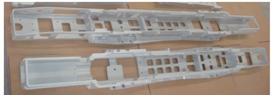
图 8 某歼击机导弹射架(尺寸为 2 300 mm×300 mm×160 mm)
