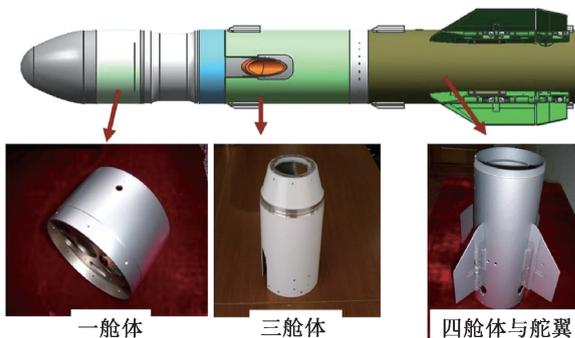
图 12 某轻型导弹舱体
