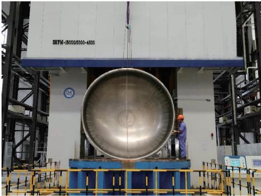
图 7 超大型板材流体压力成形机及产品
