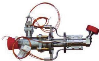
图 1 带加热器的卫星用 5 N 发动机
