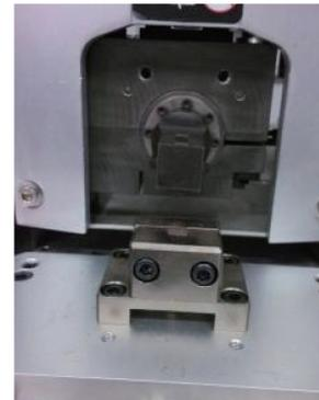
(b) 超声焊接设备焊头放大图
