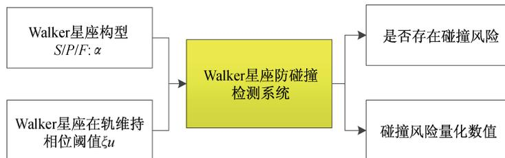
图 5 星座碰撞检测数据流程图
