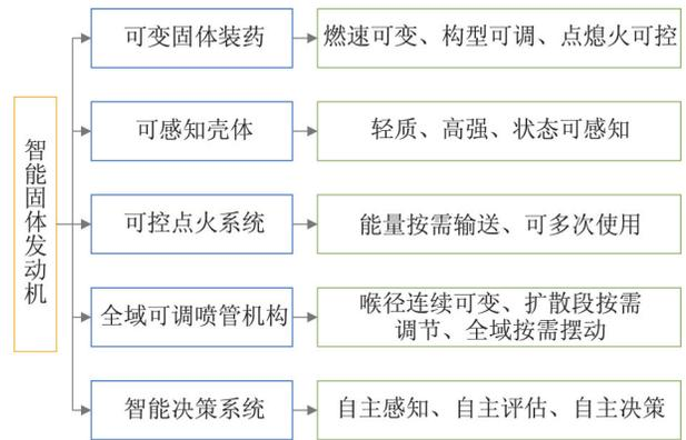
图 1 智能固体发动机功能组件模块
