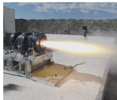
图 8 电控可熄发动机地面试车
