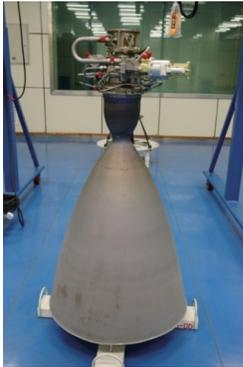
图 5 7 500 N 变推力双组元发动机
