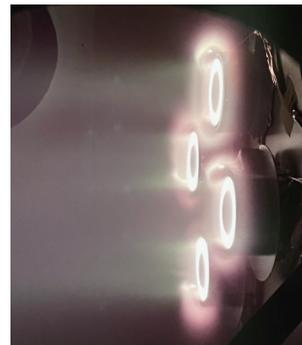
图 12 4 台 500 mN 霍尔推力器组成的推力器簇点火状态
