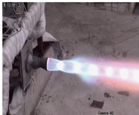
图 2 5 000 N 液氧/甲烷轨控发动机
