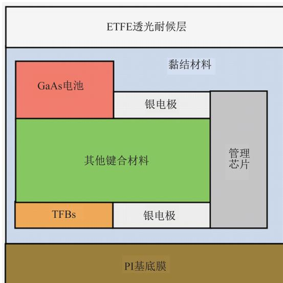
图 2 银电极与 GaAs 电池及 TFB 的连接方式
