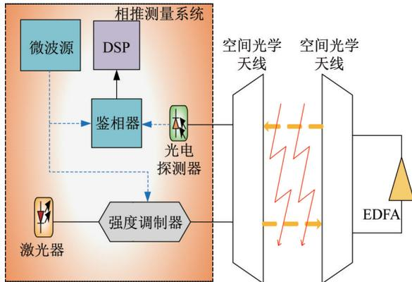
图 2 绝对延时测量原理图
