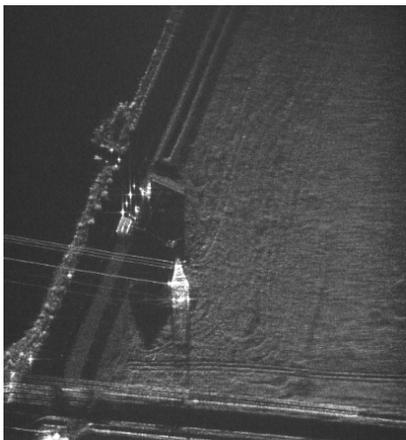
图 8 毫米波 FMCW SAR 成像结果
