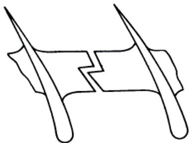
图2 “Z-lock”型凸肩阻尼结构<sup>[14]</sup>
