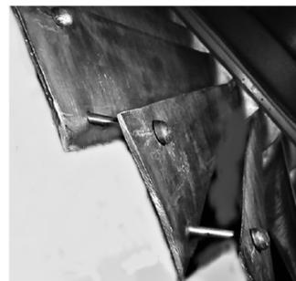
图 14 涡轮末级叶片“之”字形阻尼销<sup>[38]</sup>
