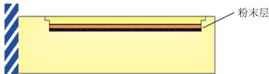
图 20 约束层粉末阻尼结构<sup>[49]</sup>
