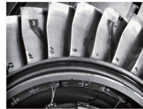
图 21 压电传感器在涡轮盘上的位置<sup>[54]</sup>
